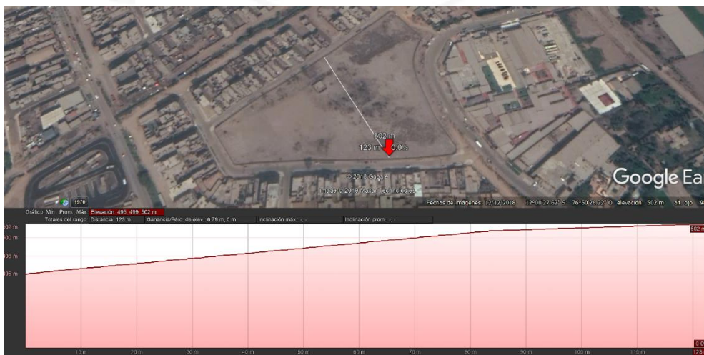
Figura 32 Perfil Topográfico Transversal del Terreno Elegido
