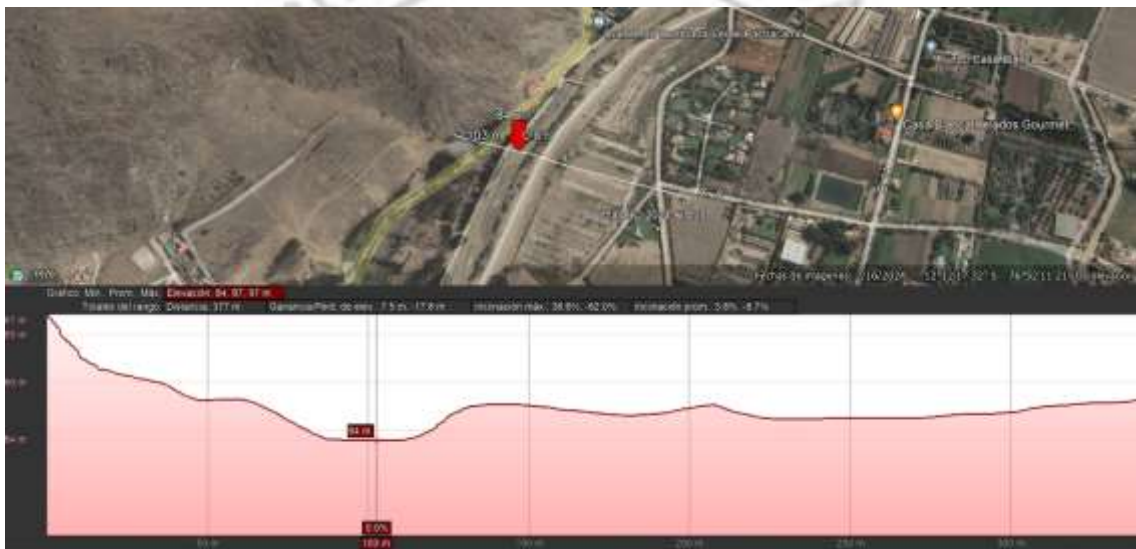
Figura 37 Corte transversal del terreno
